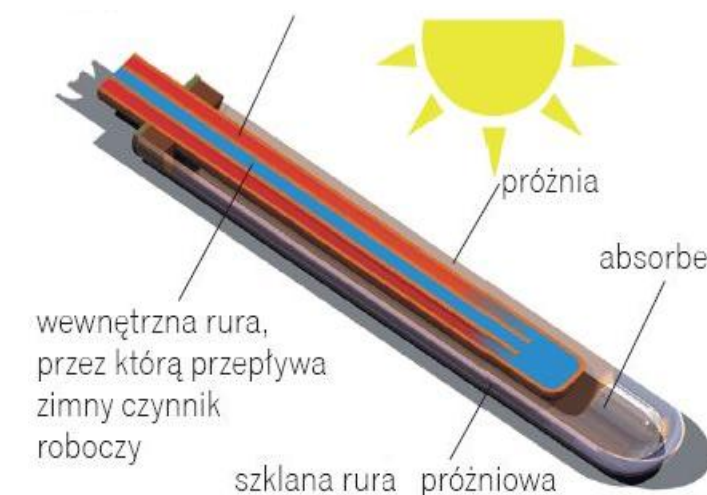
Rysunek 1. Przekrój kolektora słonecznego próżniowo-rurowego
