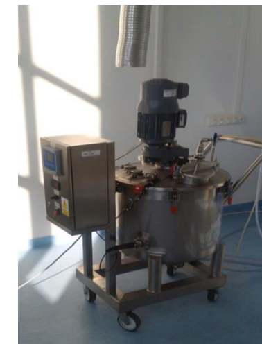
Rys.1. Bioreaktor w którym prowadzono proces bioługowania
