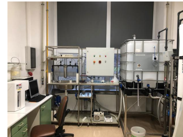
Rys. 1. Zdjęcie stanowiska doświadczalnego do filtracji wgłębnej
